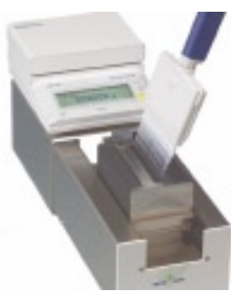
Mehrkanalwaage zur schnellen Kalibrierung von Mehrkanalpipetten
